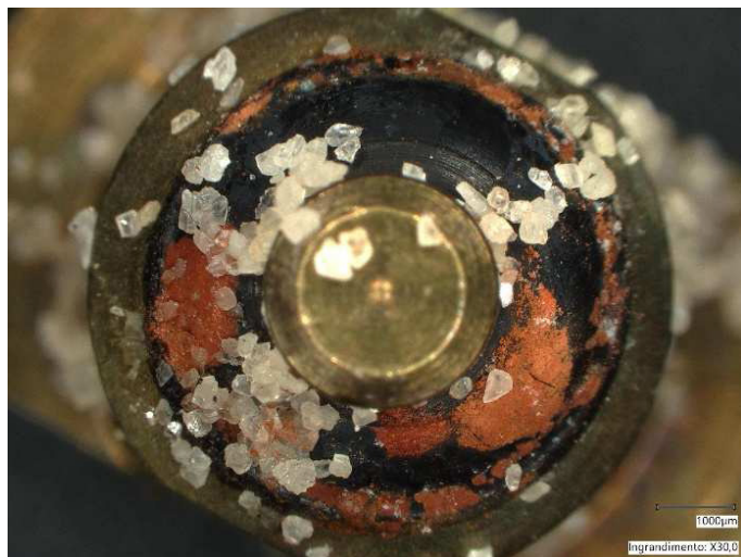
Guarnizione senza trattamento. Si può notare la presenza di impurità depositate.
