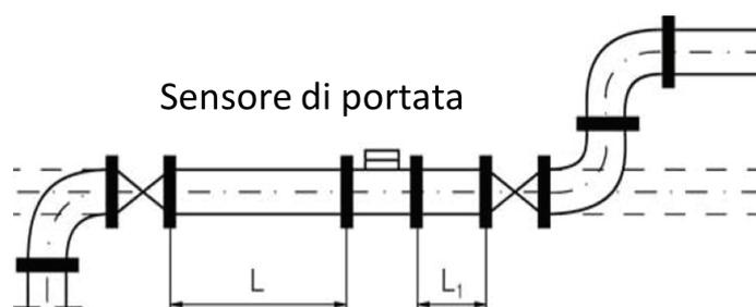
Fig.1 Installazione del sensore di portata sul misuratore di calore
