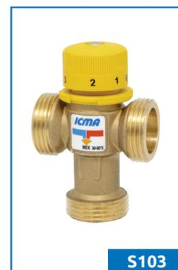
Термостатический смеситель оснащен системой безопасности от ожогов кипятком. Подача горячей воды прекращается автоматически в тот момент, когда подача холодной воды по какой-либо причине остановлена.
