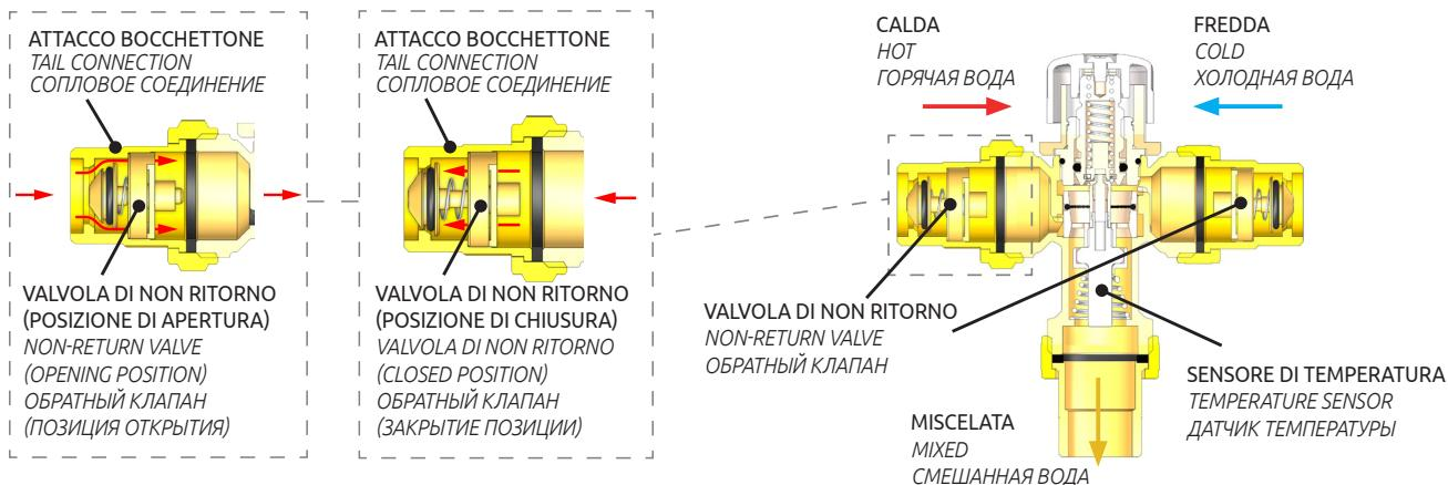
**SCHEMI APPLICATIVI/ APPLICATION DIAGRAMS/ МОНТАЖНАЯ СХЕМА**
