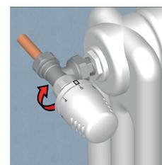
Зафиксировать термоголовку. Для этого полностью накрутить хромированное кольцо на серое кольцо. Затянуть подходящим ключом.
