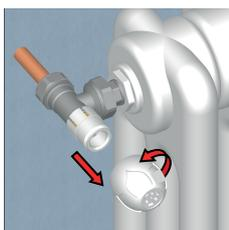
Полностью снять ручку с вентиля, поворачивая ее против часовой стрелки.
