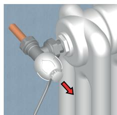
Снять защитный колпачок с ручки, при помощи маленькой отвертки.
