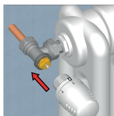
Установите термоголовку в положение 5. Это облегчит дальнейший монтаж. Установите термоголовку, таким образом чтобы индикатор был хорошо виден.
