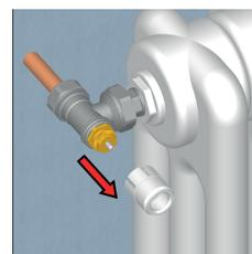
Снять белый адаптер с корпуса вентиля, потянув его «на себя».
