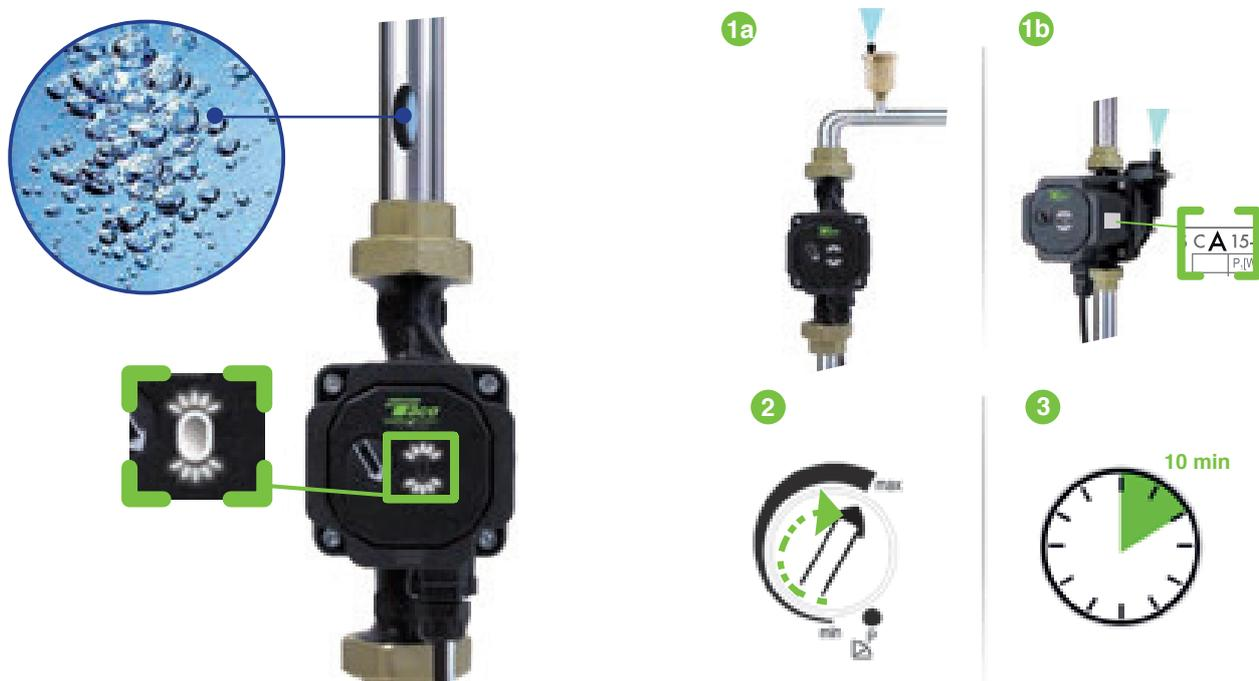
**Рис. 6.2 Заполнение и обезвоздушивание системы**
