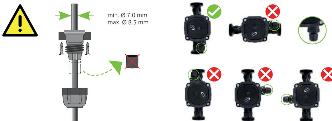
Для кабелей диаметром от 7 мм до 8,5 мм, пожалуйста, снимите резиновое уплотнение на кабельном вводе, чтобы можно было вставить кабель. В этом случае циркуляционный насос может быть установлен только кабельным винтом вниз.
